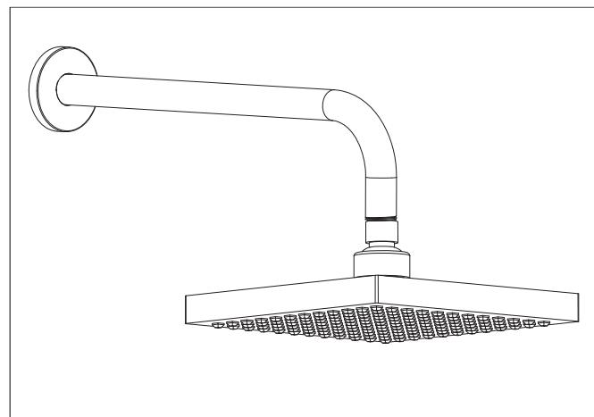
CZ - Přišroubujte horní sprchu a ujistěte se, že vývod na vodu je ve vertikální poloze, pak nasuňte krycí růžici tak, aby se plně dotýkala zdi.
