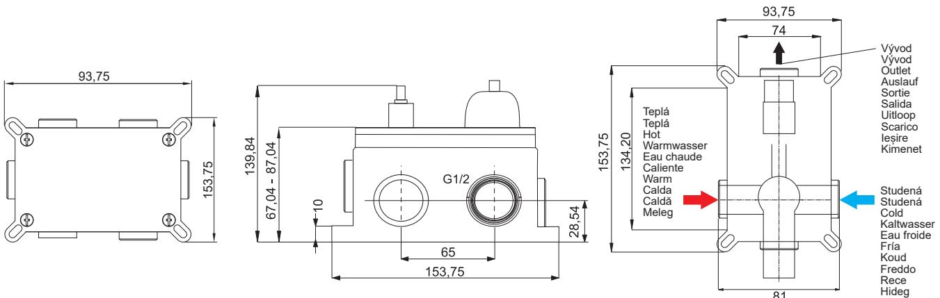
**CZ** Trojcestná varianta (s přepínačem - 3 polohy)
