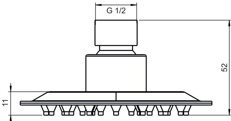
CZ - Průtok: 31,2 l/min při 5bar
