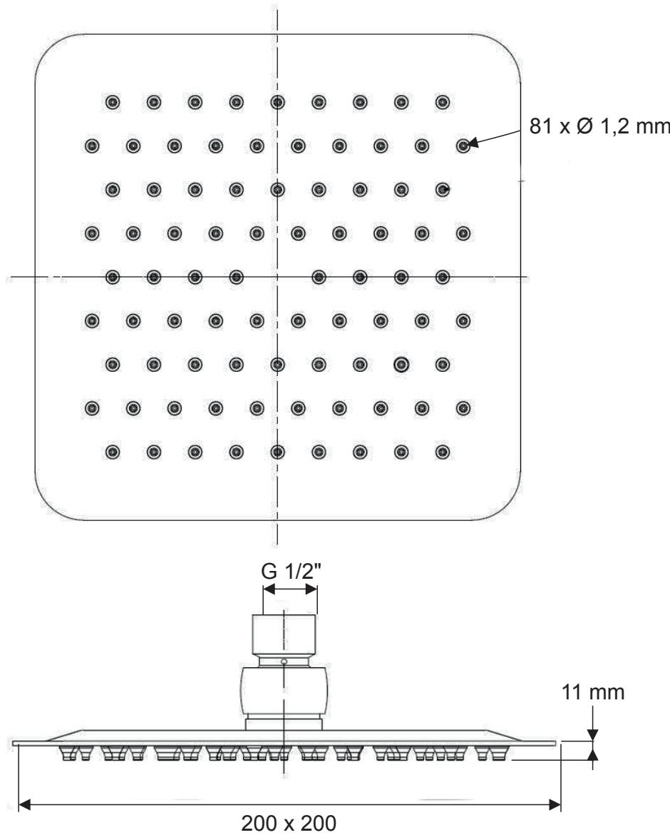
**CZ** - Vodní kámen z trysiek sprchové hlavice odstraňujte pravidelně prsty. Předmětem reklamace nejsou závady způsobené zanesením sítěk, trysiek hlavových a ručních sprch vodním kamenem, nečistotami z vodního rádu (včetně vodního kamene). Nepoužívejte čistící prostředky s obsahem kyselin a abrazivní čistící prostředky.
